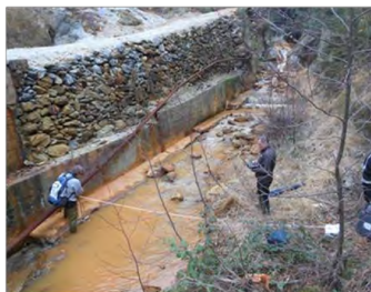
MISURE DI PORTATA NEL TORRENTE
