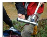
MISURE DI PORTATA NEL TORRENTE
